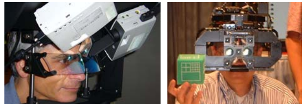
図1 左) 広視野 HMPD[kk2], 右) 遮蔽対応 HMD [kk3]
